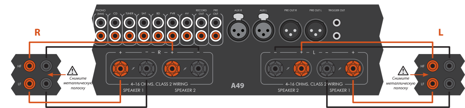
Устройство А49, подключенное к двум динамикам с помощью двойного подключения.
