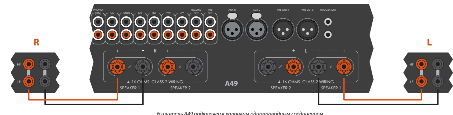
Усилитель А49 подключен к колонкам однопроводным соединением.
