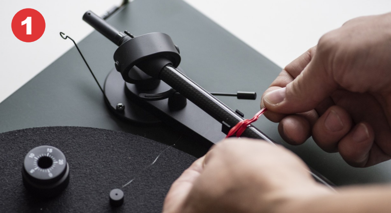
1 Снимите противовес и грузик антискейтинга с тонарма. Зафиксируйте тонарм с помощью транспортного фиксатора.
