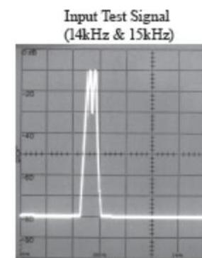
Если усилитель перегружен, то обнаруживается разница в форме волн входного и выходного сигналов. Когда различия превышают 0.3% (эквивалентно гармоническим искажениям 0.3%), схема включает индикатор и динамический электронный аттенюатор на входе усилителя уменьшает входной уровень для предотвращения дальнейшего увеличения искажений.
