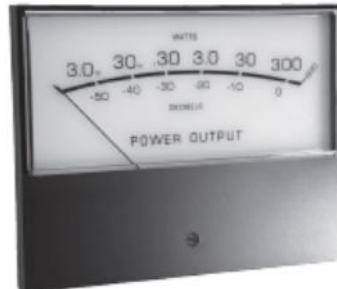
Когда указатель достигает пика, он на мгновение задерживается чтобы человеческий глаз смог увидеть его, затем падает. Он работает почти в десять раз быстрее, чем профессиональный VU измеритель. Переключатель на передней панели предназначен для переключение измерителя в режим Watts Hold Mode (Режим удержания ватт). Это позволяет указателю быстрее двигаться вверх и увеличивает время задержки в пиковом положении.
