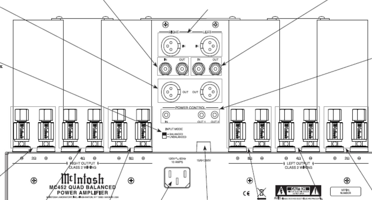
Подключите шнур питания к работающей розетке АС. Правильное напряжение питания указано на задней панели MC452
